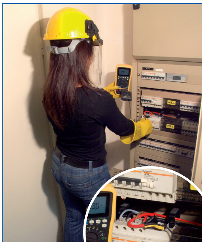
Den unika flexibiliteten hos en Rogowskispole gör att den passar i alla.
